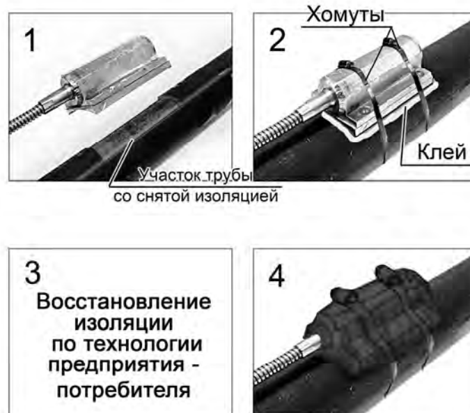
Рисунок 2.5 – Порядок работ по установке и креплению ППТП подземного исполнения с корпусом типа «К2» на трубопроводе с помощью КМЧ
